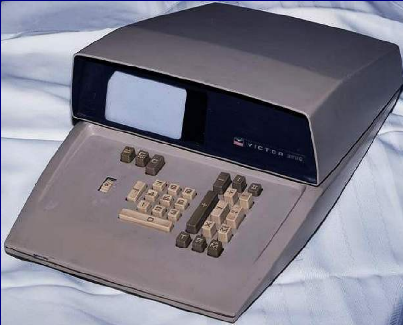
Esimene integraalskeemidel töötav elektronkalkulaator, personaalarvutite eelkäija, firma „Victor Comptometer” 1965. aasta „Victor 3900“.
