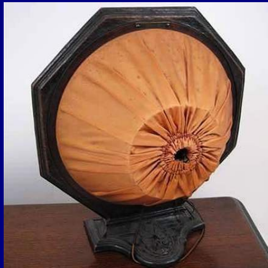
RCA kaasaegse valjuhääldajaga kõlar, eest- ja tagantvaates. (Valjuhääldaja on kaitseks tolmu eest kaetud riidest kotiga.)
