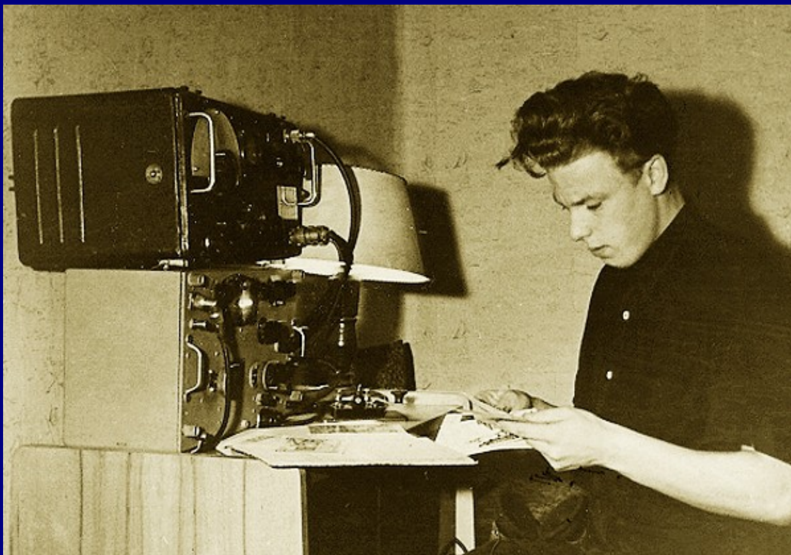
UR2DW - Tõnu Elhi koduse raadiojaama taga 1962. aastal. Laua tööstuslik vastuvõtja „BC342“ ja omaehitatud CW saatja.
